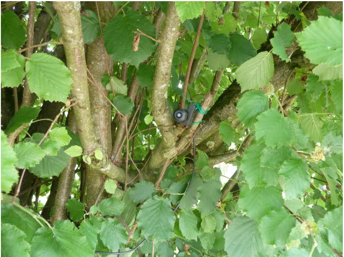
Abbildung 11 In einem Strauch installierter Batlogger
