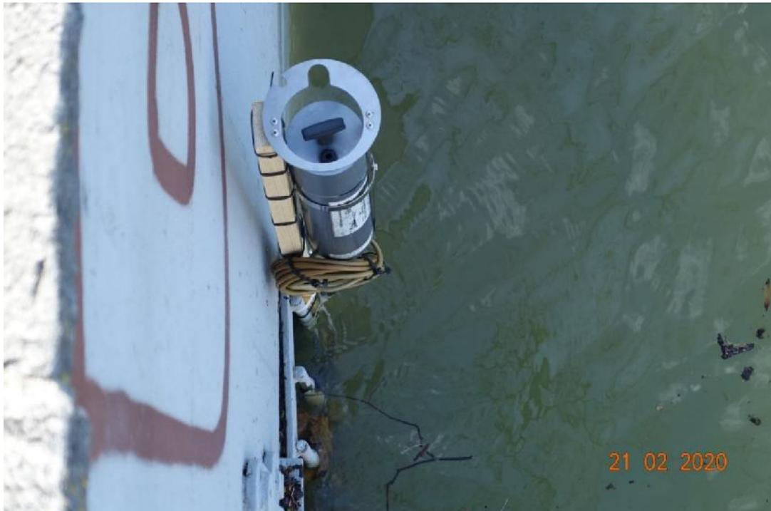
Bild 2: Wasserstandssonde am Ablauf des Anlagensees
