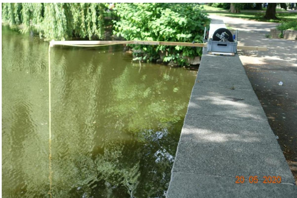
Bild 1: Profilaufnahme von  $T_w$ , Lf,  $O_2$  bzw. SSI, 2 m von der ablaufseitigen Mauer des Anlagensees entfernt (Tiefenprofil: 0,0; 0,5; 1,0; 1,5; 2,0 m)
