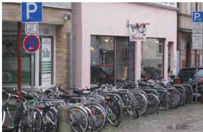
Typ: Anlehnbügel, Aufstellart: Reihenparkanlage
