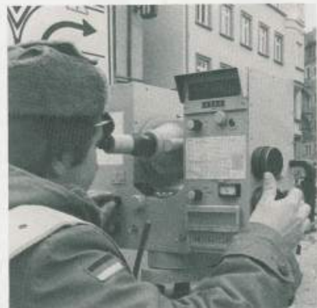
Fortschritt in der Vermessungstechnik: die bewährte Kreuzscheibe ist vom registrierenden elektronischen Tachimeter (RegElta) überholt worden.
