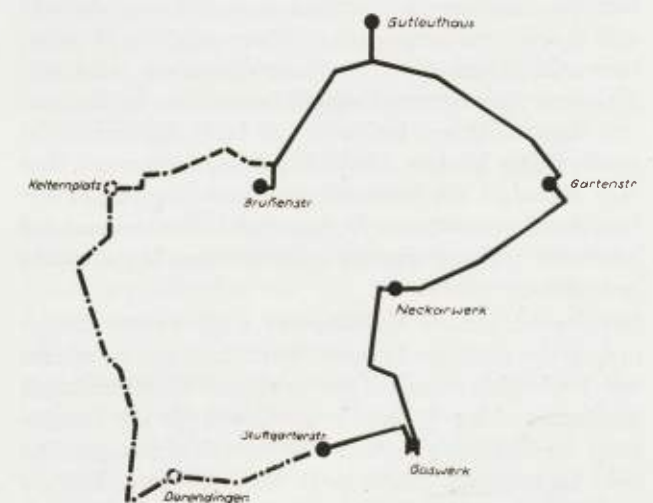
Gas-Mitteldrucknetz, gestrichelte Linie: geplante Bauvorhaben
