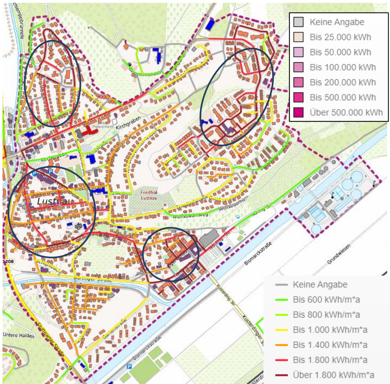
Abb. 35: Untersuchungsgebiet Lustnau mit Wärmedichte (Quelle: Smart Geomatics)
