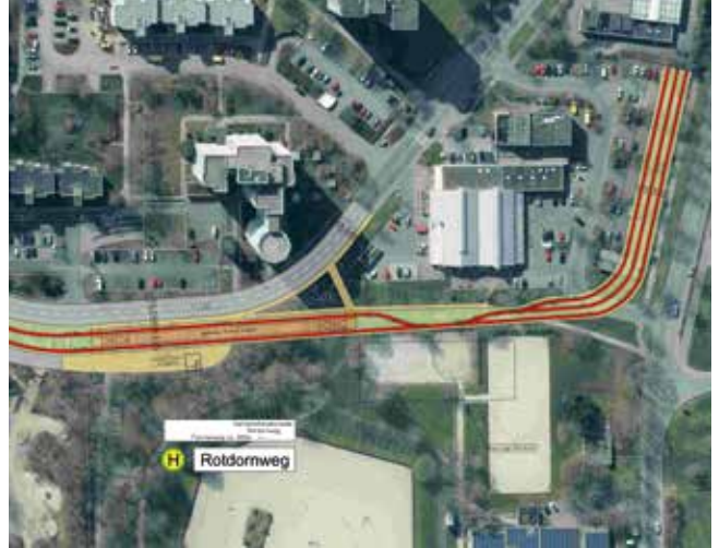
Abb.110: Regionalstadtbahnhaltestelle Rotdornweg mit Zugabstellfläche westlich Vogelbeerweg (Variante), Stand 17.05.2017 (Quelle: Planungsgemeinschaft Regional-Stadtbahn Neckar-Alb Mailänder Consult GmbH / Schüßler-Plan Ingenieurgesellschaft mbH, Karlsruhe)
