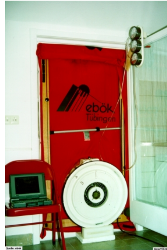
Blower-Door: Messvorrichtung zum testen und auffinden von Undichtigkeiten
