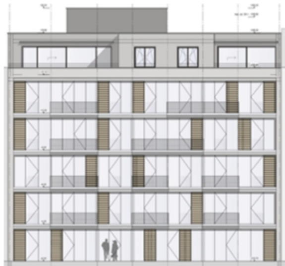
Süd: 70% Fensterfläche / Fassadenfläche
