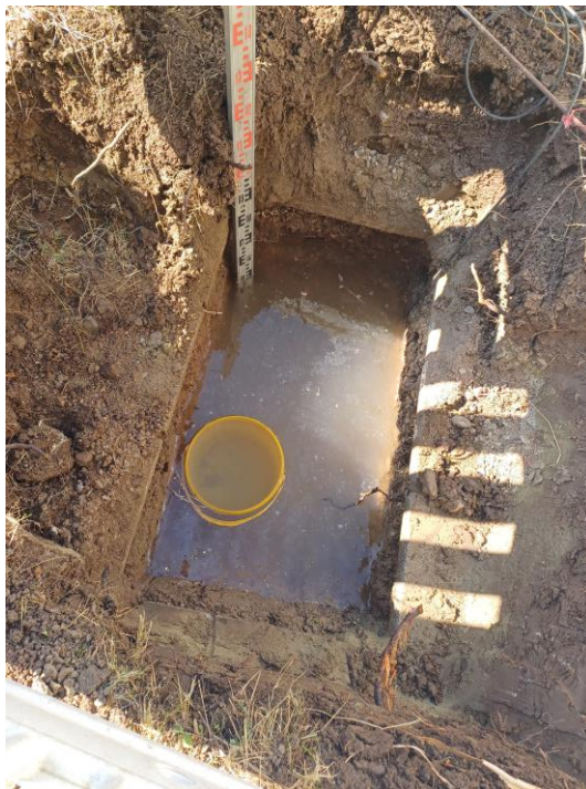
Foto Nr. 8 Versickerungsversuch SG4 – Ende 6,5 h
