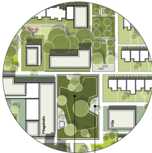
Abgesenkte Fläche für Retention
